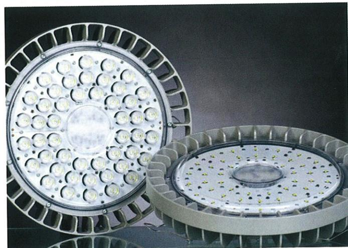
**Abb.:** Je nach Auswahl der optischen Linsen gibt es den »HB380« mit 120°, 60° und 40° Abstrahlwinkel. Er ist mit verschiedenen Lichtströmen zwischen 11900 lm und 21000 lm verfügbar, so lassen sich Hallen von 5 m bis 30 m Höhe optimal in der gewünschten Lichtstärke ausleuchten.
